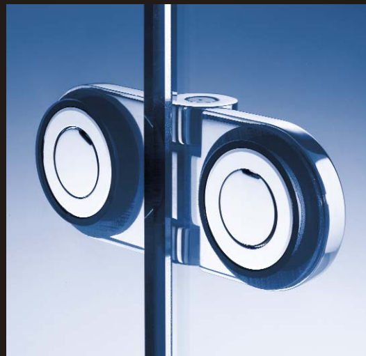
Beschlag Versenkte Punkte schaffen plane Glasinnenflächen
